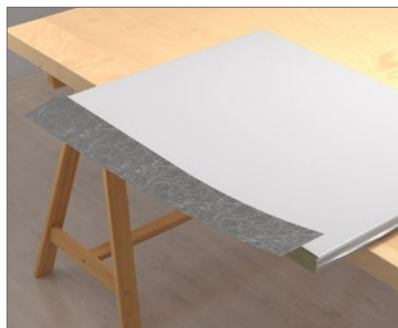
3. Tilpass med 5 mm overlapping på forsiden, og trykk.
